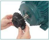
**INSERT SCREWS AND LOCATE ON SHAFT**
